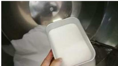
+3分 混合 【運転条件 22rpm 30s 正回転のみ 60Hz揺動 45度～ -45度】
